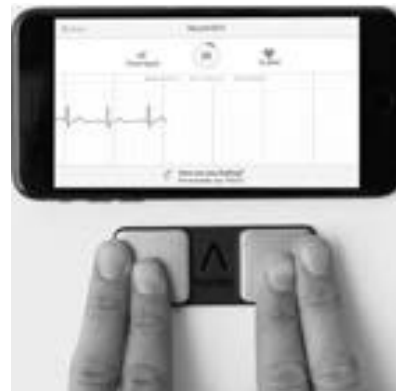
Hình 2. Cách tiến hành ghi điện tim một chuyển đạo DI của thiết bị Kardia
